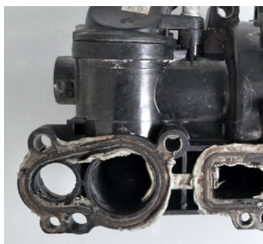
Abb. 5: Undichtigkeiten durch zusätzliche Dichtmittel (Schadensbild)
